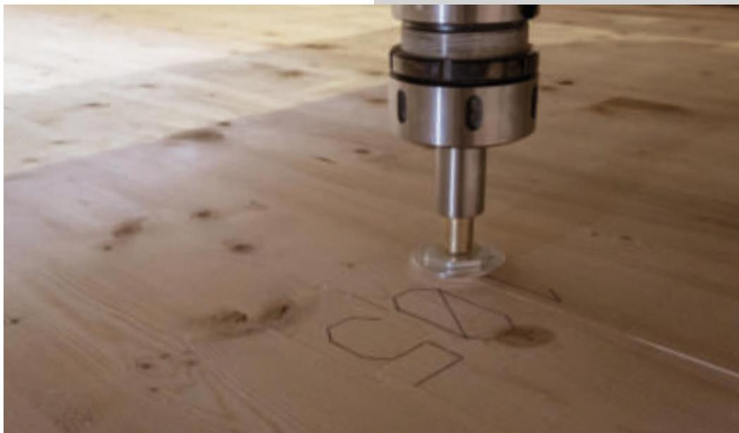
I pannelli prodotti da XLAM DOLOMITI possono essere contrassegnati numericamente in produzione durante le lavorazioni al CNC, questa operazione garantisce un'indubbia identificazione in cantiere.
